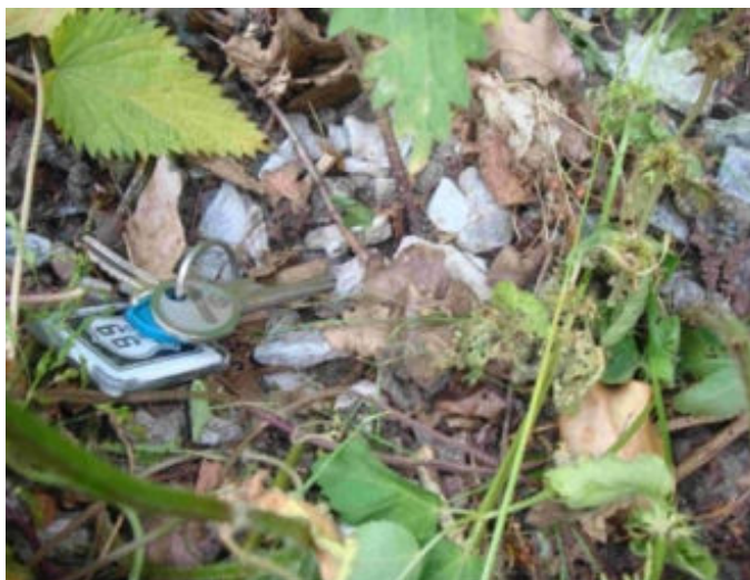
Figuur 5-3: Berm van een weg in de regio Goor, waarin stukjes asbesthoudend materiaal te vinden zijn die in de vorige eeuw werden aangebracht om de weg te verharderen.
